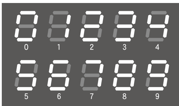
図 2 7 セグメント LED で表示した 0 ～ 9 の数字
